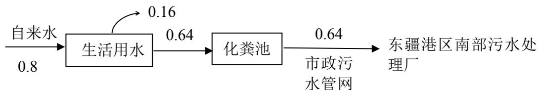
图 1-1 本项目给排水平衡图（单位 m<sup>3</sup>/d）
